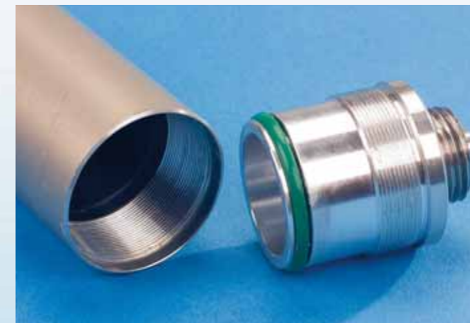
Der geöffnete Feinwerkbau-LP-Tank zeigt die dünnen Wände einer Alu-Kartusche. Der Dichtungsring des Ventilstücks sitzt (von innen gesehen) vor dem Gewinde, so daß kein Druck gegen die Gewindengänge arbeitet. Das Außengewinde sollte regelmäßig mit Spezialfett dünn eingerieben werden.
