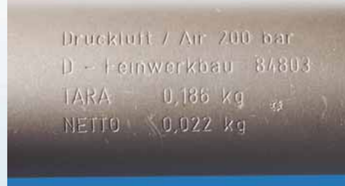
...die die Hersteller aber ablehnen, weil sie keine Sicherheit vor künftigen Schäden bietet. Ältere Kartuschen (hier zwei LP-Tanks von FWB) tragen noch deutlich weniger Infos, allenfalls das Herstellungsquartal (III/98), oder nicht einmal das. Die π-Prüfung verpflichtet den Hersteller zur 10-Jahres-Frist, aber ohne Prüfzeichen kann man nur an die Vernunft der Besitzer appellieren.
