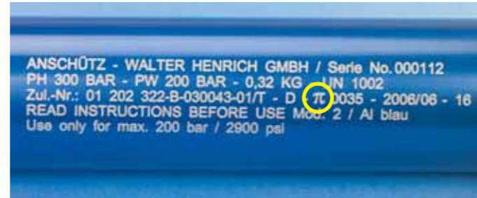
Das "π" belegt die Tank-Zulassung nach Richtlinie 1999/36/EG ("ortsbewegliche Druckgeräte"), es folgt das Herstellungsdatum 2006/06. Nach zehn Jahren müßte eine neue Prüfung erfolgen...
